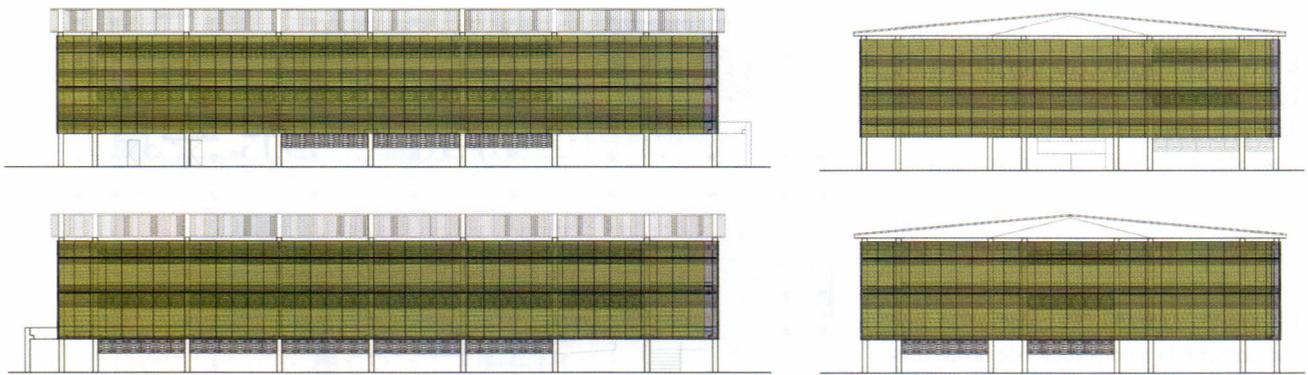
Diversas foram as soluções elencadas, em projeto, para dar boas condições térmicas aos ambientes internos da escola. Uma das formas de controlar passivamente a temperatura é a criação de uma segunda pele constituída por elementos vazados em toda a envoltória do edifício. Os brises garantem que a luz solar não atinja diretamente as paredes e janelas da escola, enquanto a distância entre eles permite que o excesso de calor seja dissipado por ventilação natural
