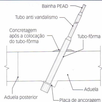
Detalhes do projeto da ponte Roberto Marinho, em São Paulo, mostram a composição dos estais. Tubos antivandalismo protegem as cordoalhas até 3,5 m do nível do tabuleiro. Uma camada de concreto na face superior do tabuleiro em torno do tubo visa evitar infiltrações de água. Todos os cabos foram equipados com sistemas de amortecedores.
