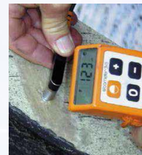
Espessura de revestimento galvanizado por imersão a quente (tinta removida)
