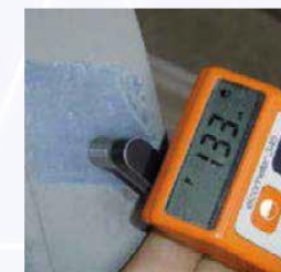
Indicação de espessura total de revestimento sobre barra lateral limpa da escada de cabo de aço
