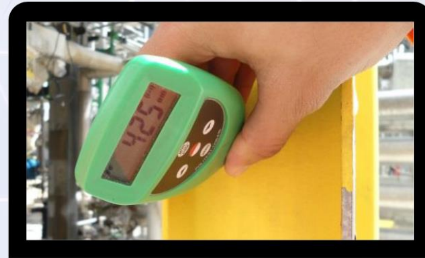
Galvanizado + Pintura = Sistema Duplex (425µm)
