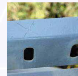
Revestimento em pó exposto, sujeito a um ensaio de aderência por corte transversal
