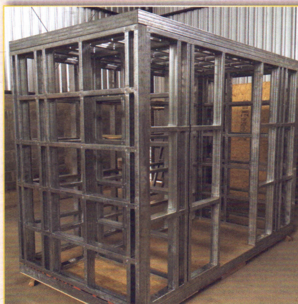
Exemplo de estrutura confeccionada com perfis de aço feitos a partir de chapas usada na fabricação de módulos habitáveis, desenvolvidos pela Allmas.
